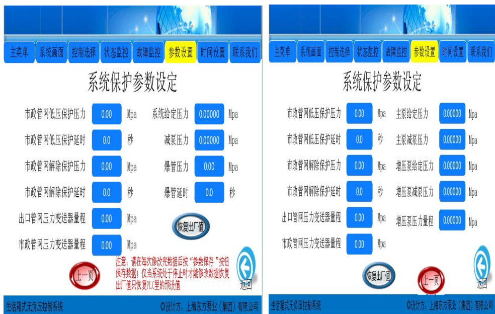
左（不带增压泵的参数人机界面截图） 右（带增压泵的参数人机界面截图）
