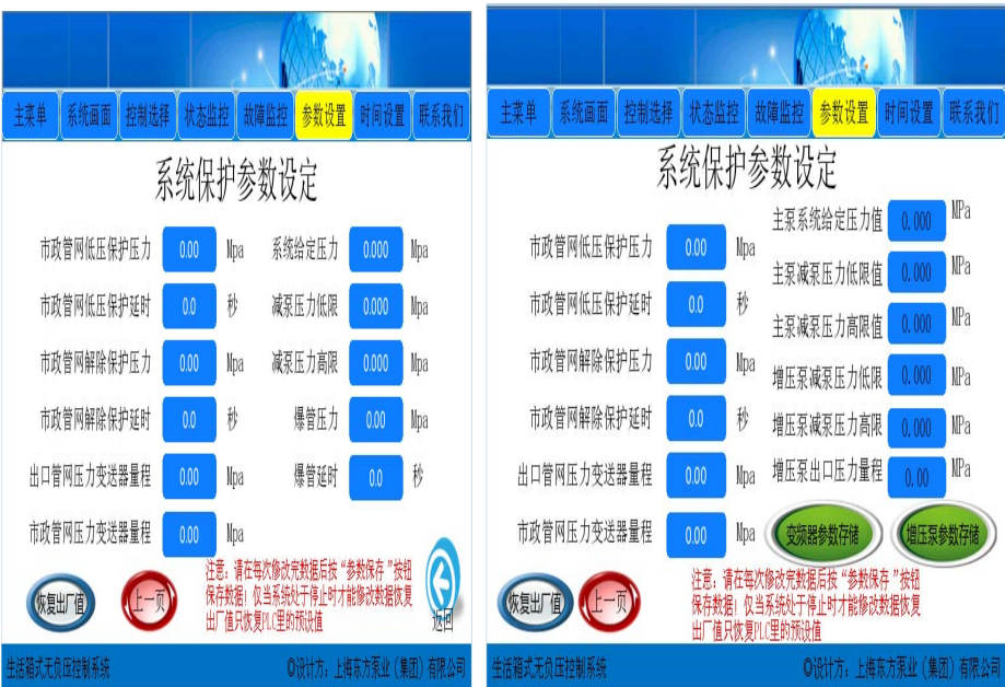
图16（箱式（无负压）叠压控制柜中人机界面操作界面图）
