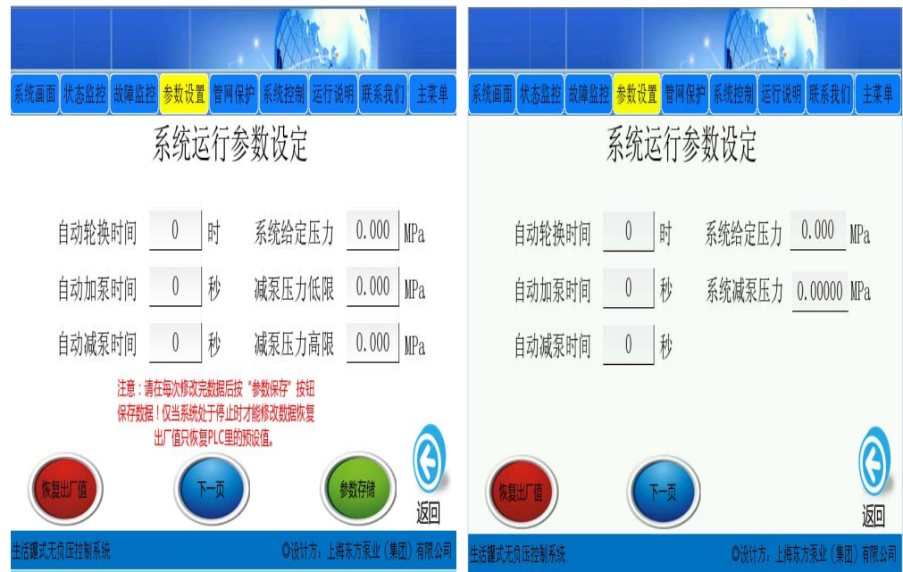
左（采用ABB变频器的人机界面截图） 右（采用丹佛斯变频器的人机界面截图） 图12（罐式（无负压）叠压控制柜中人机界面操作界面图）
