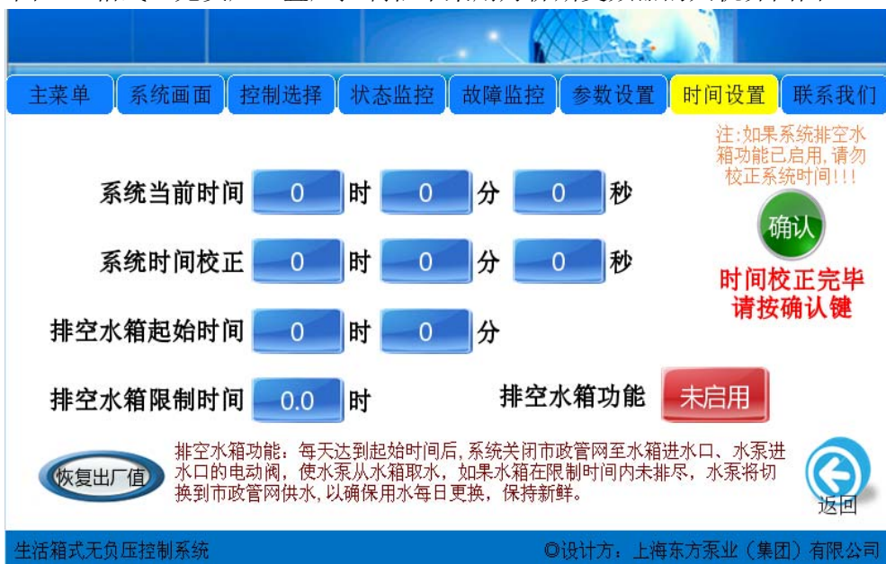
图18（箱式（无负压）叠压控制柜中采用丹佛斯变频器的人机界面图）
